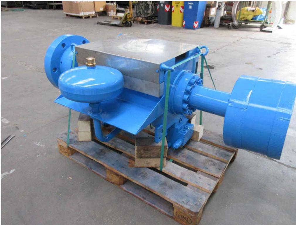
*Figura 6: Ritegno idraulico del Tipo 1 dopo l'intervento di manutenzione ed adeguamento*
